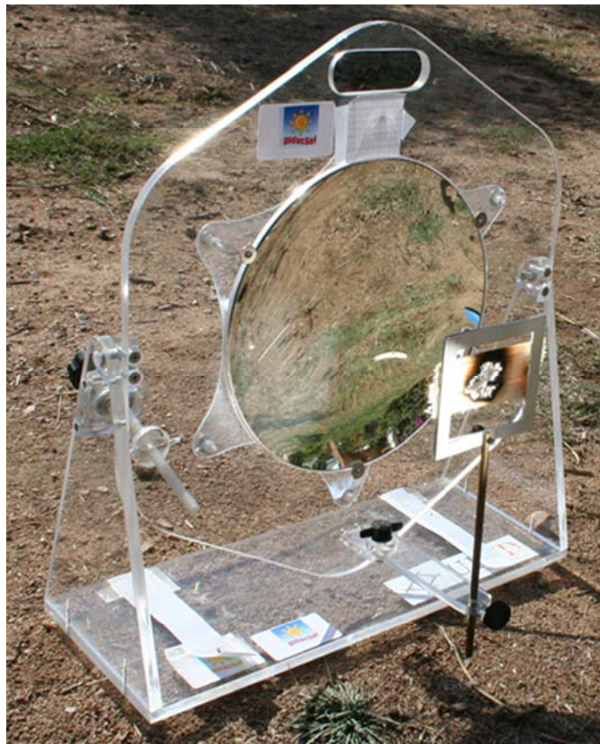
La lumière solaire concentrée par un miroir parabolique permet d'enflammer divers matériaux
