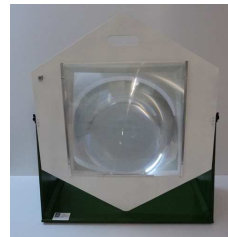
Concentration de l'énergie solaire avec une lentille de Fresnel
