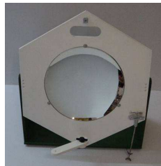
Concentration de l'énergie solaire avec un miroir sphérique
