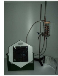
Capteur thermique, thermosiphon et eau chaude solaire
